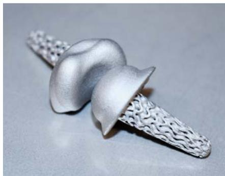
Individualisiertes Fingergelenksimplantat, in einem speziellen 3D-Druck-Verfahren gefertigt
